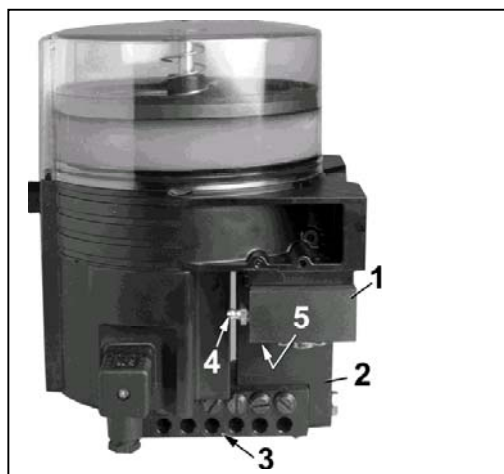
Рис. 13 QLS 301 с нижним расп. SSV. 1-Микровыключатель 3- SSV. 2-Контрольный штифт 4-Пресс-маслёнка
